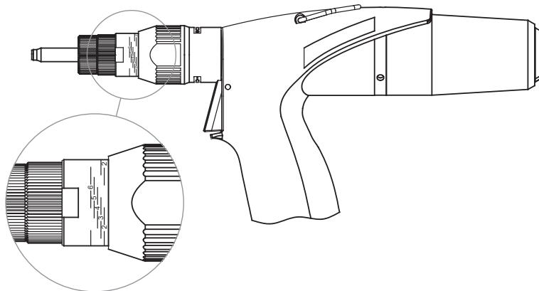
10. Mettre l'appareil sous alimentation d'air comprimé, ouvrir l'alimentation d'air pour ne pas empêcher le sertissage.
