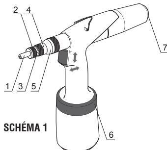
L'outil est équipé d'un nez et d'un tirant pour les écrous à sertir M8. Les écrous ayant un diamètre différent nécessitent un changement de nez, de tirant et une modification du réglage de l'outil de la manière suivante :
